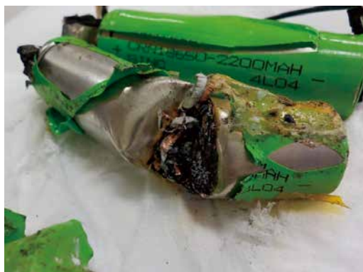
▲発火原因となった小型充電式電池
