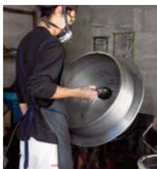
星掛け。2mm程度の芯(球状)に、水で練った材料と乾いた材料を交互に何度も掛けて、すこすこ「星」(花火の光を作る火薬)を大きくします。
