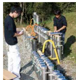
打ち上げ準備。資格を有するスタッフが、筒を並べ玉を込め、導火線(電気点火コード)をつなぎ、プログラムに合わせたセッティングをします。
