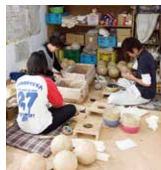
玉込め。半球状の玉皮の内側に星を並べて、内側に割薬(玉を割るための火薬)を入れます。2つの玉皮を合わせて丸い一つの玉に完成させます。
